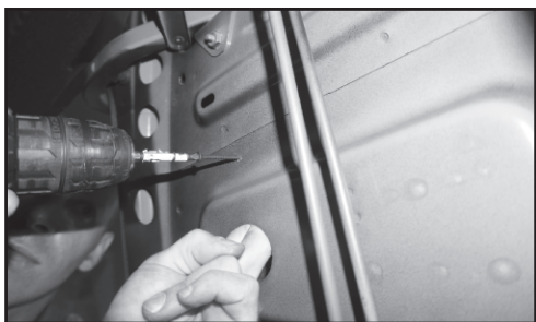
19. Закручиваем из багажника саморезами 3,5x51 через металл.
