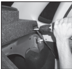
18. Саморезами 3,5x25 прикручиваем полку к металлу
