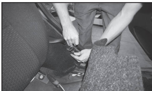
2. Откручиваем ремни безопасности, чтобы снять пластмассовую полку.
