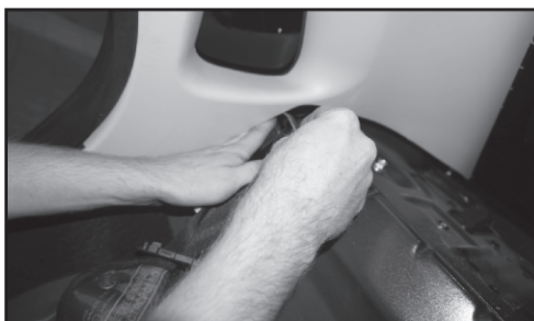
10. Протягиваем провода длиной 1,8 м от места крепления колонок, прокладывая провод под обивками и под коврики салона к месту установки магнитолы.
