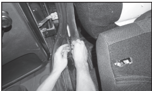
8. Вытаскиваем провода в гофре.
