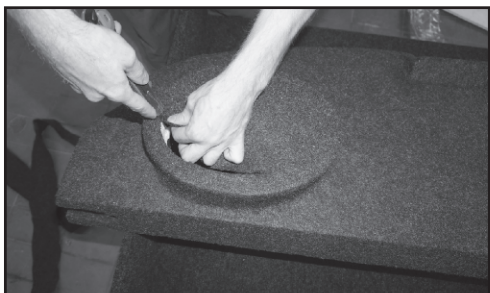
4. Прорезаем ткань на полке в местах колонок.
