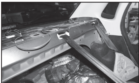
8. Вытаскиваем провода в гофре.
