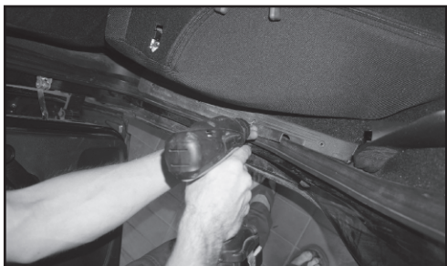
6. Откручиваем пластиковый порожек
