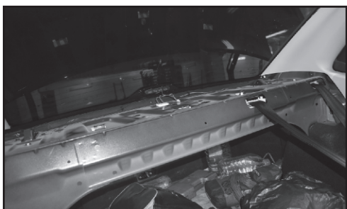
3. После снятия пластмассовой полки боковые ремни безопасности закручиваем на место.
