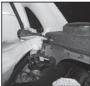
18. Саморезами 3,5x25 прикручиваем полку к металлу
