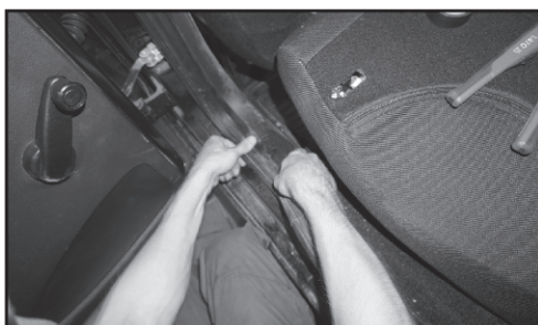
13. Устанавливаем на место уплотнитель и пластиковый порожек.
