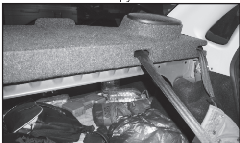
16. Устанавливаем полку на место и продеваем ремни безопасности. Центральный (средний) ремень безопасности прикручиваем болтом.
