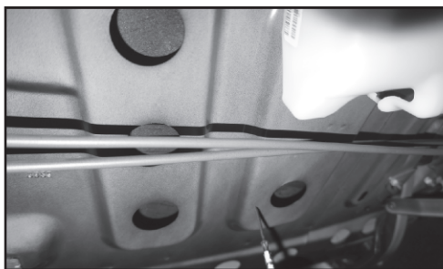
19. Закручиваем из багажника саморезами 3,5x51 через металл.
