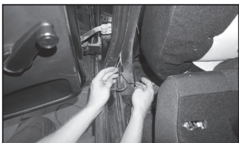
12. Делаем скрутку соединяя провода: синий с красным, черный с желтым. С другой стороны машины, вместо синего используем зеленый провод.
