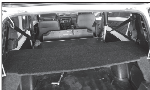
18. Устанавливаем вторую боковину аналогично первой, кладем на боковины крышку. Внешний вид.
