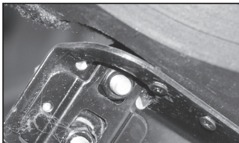
14. Устанавливаем боковину на место, прикручиваем ее снизу саморезами (3,5x25 мм), 2шт.
