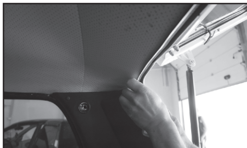
10. Закручиваем все саморезы, убираем все провода.
