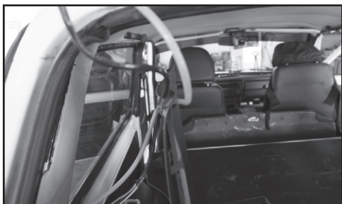
6. Снимаем пластик, отсоединив от него провода.
