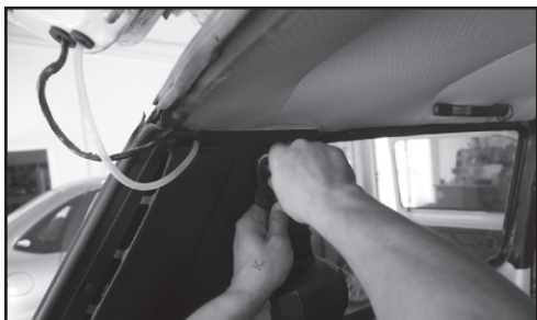
3. Выкручиваем болты крепления ремня безопасности.
