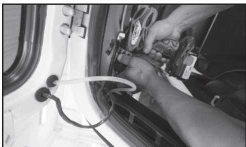
5. Выкручиваем болты крепления пластиковых боковин.
