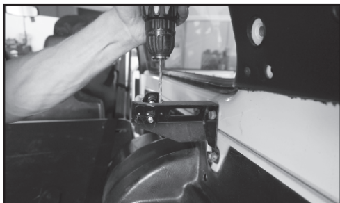
11. Рассверливаем сверлом диаметром 3,5-3,7 мм кронштейн крепления спинки сиденья (два отверстия).
