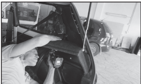
14. Устанавливаем боковину на место, прикручиваем ее снизу саморезами (3,5x25 мм), 2шт.
