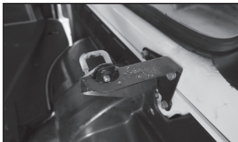
11. Рассверливаем сверлом диаметром 3,5-3,7 мм кронштейн крепления спинки сиденья (два отверстия).
