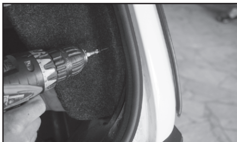
16. Второй саморез прикручиваем чуть ниже.
