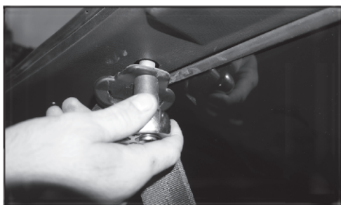
3. Снимаем пластиковую заглушку. Откручиваем болт ремня безопасности. Внимание! Болт придется ставить обратно, поэтому смотрите в каком порядке стоит шайба.
