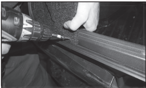
12. Двумя саморезами 3,5 x 41 прикручиваем боковину к кузову автомобиля
