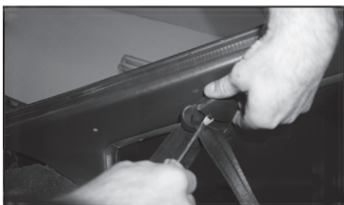
3. Снимаем пластиковую заглушку. Откручиваем болт ремня безопасности. Внимание! Болт придется ставить обратно, поэтому смотрите в каком порядке стоит шайба.
