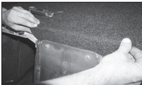
4. Двумя саморезами (3,5x51) прикручиваем полку к металлу с обеих сторон.
