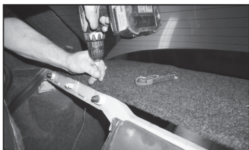
4. Двумя саморезами (3,5x51) прикручиваем полку к металлу с обеих сторон.
