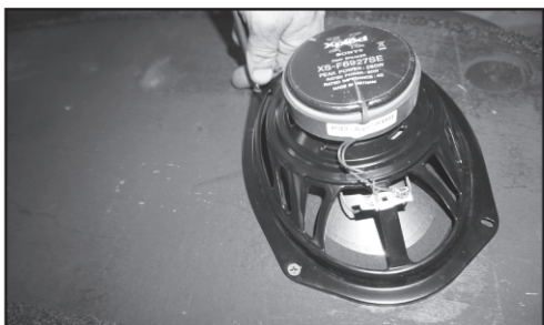
2. Прикручиваем динамики саморезами (3,5x25, 8 шт).
