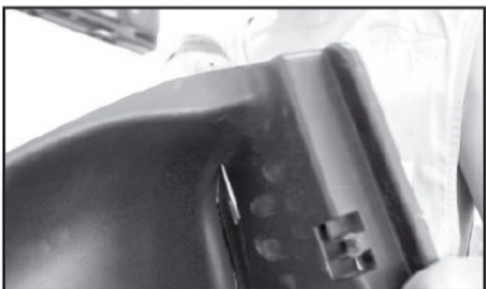
2. Отрезаем часть боковины, таким образом, чтобы пластмассовая обивка после сгиба заходила под деревянную боковину от полки.
