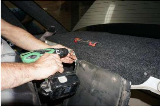
Двумя саморезами 3,5\*25 прикручиваем ее к полке, затем
