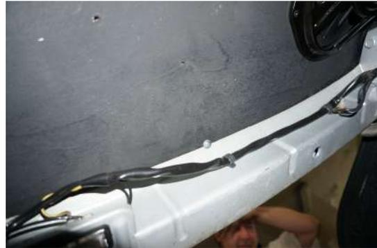
Двумя саморезами с прессшайбой 4,2\*16 прикручиваем в край железа, притягивая полку.
