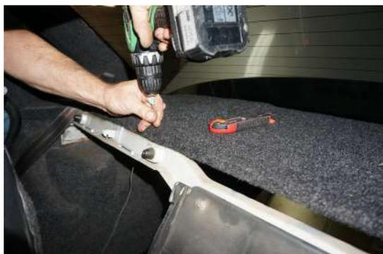
Двумя саморезами (3,5\*51) прикручиваем полку к металлу с обеих сторон.
