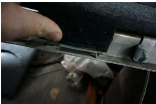
Снимаем пластиковую полку, вытащив из крепления
